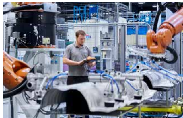
Automatische Produktion von Hitzeschildern in Sevelen (CH)
